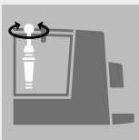
Filter in Wassertank eindreihen
