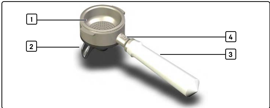
Abb. 6 Filterträger mit Zweitassensieb und Silikonaufsatz
